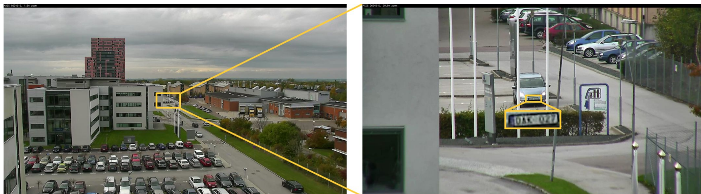
Модель AXIS Q6045-E с разрешением HDTV 1080p позволяет рассмотреть номерной знак автомобиля на расстоянии 275 м. Слева приведен широкоформатный снимок, а справа – 20-кратный оптический зум.
