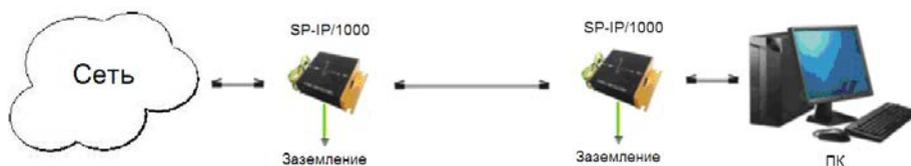
Рис.3 Подключение SP-IP/1000
