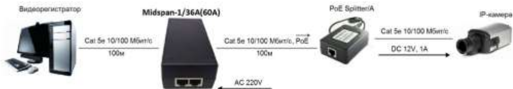
Рис. 5 Схема подключения PoE-инжекторов Midspan – 1/36A(60A) с PoE Splitter/A
