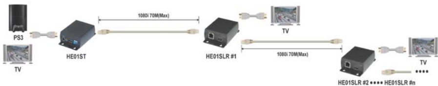
Рис.10 Схема подключения передатчика HE01ST и приемника HE01SLR.
