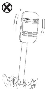
Монтируйте датчик на твердую устойчивую поверхность.
