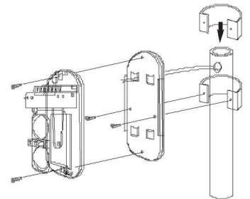
Схема установки двух датчиков на один кронштейны (спина к спине)
