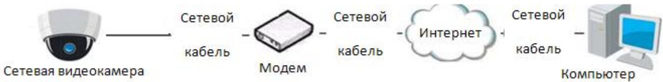
Рисунок 3.4: Доступ к сетевой камере с использованием PPPoE подключения.
