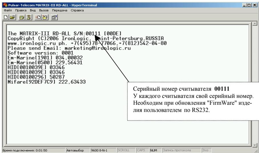
Для вывода на экран программы данных об изделии ( серийный номер) нажмите клавишу на клавиатуре ПК «I» У каждого считывателя свой серийный номер, который необходим при обновления "FirmWare" изделия пользователем.
