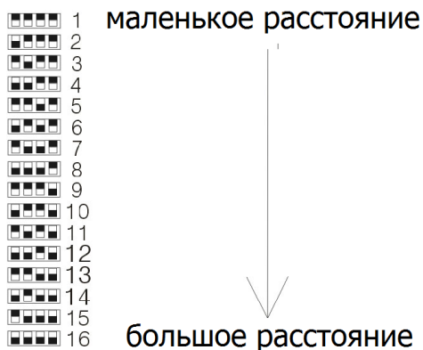
Рис.3 Комбинации DIP-переключателей на приёмнике RA-CPD
