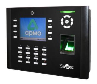
Биометрический терминал ST-FT680EM поддерживает следующие режимы распознавания: только палец (идентификация 1:N), ПИН плюс отпечаток пальца (верификации 1:1), карта плюс отпечаток пальца (верификации 1:1), только карта, карта плюс код, ПИН плюс код. Возможен автономный режим работы терминалов, т.е. без необходимости подключения терминалов к сети Ethernet, с использованием USB-накопителей для переноса данных.
