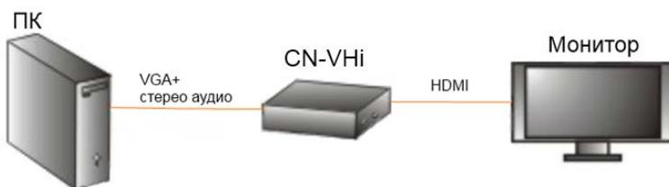
Рис. 3 Схема подключения преобразователя CN-VHi
