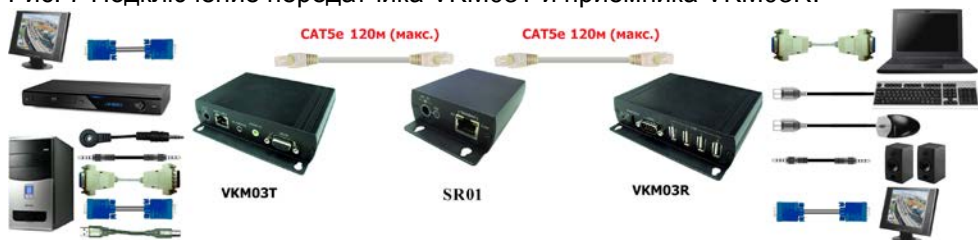
Рис. 7 Подключение передатчика VKM03T и приёмника VKM03R.
