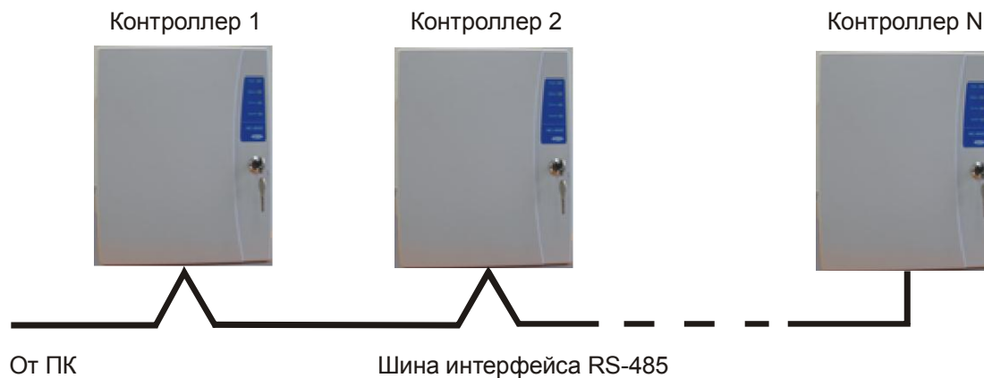
а). Соединение контроллеров по топологии «Шина».
