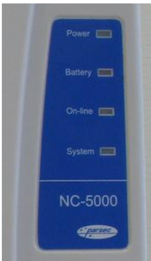
Рисунок 12. Внешняя индикация состояний контроллера.
