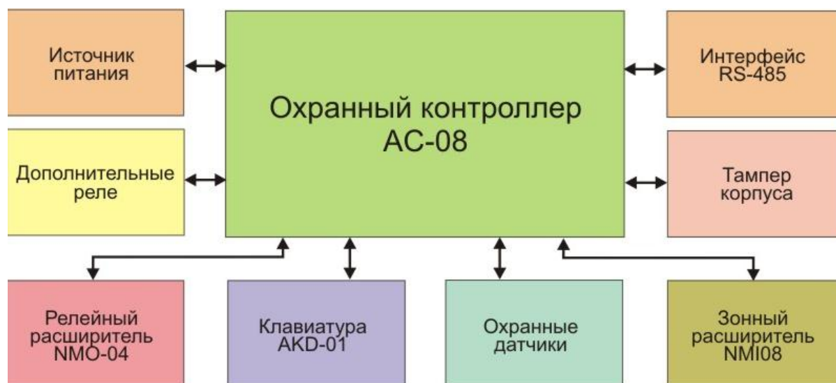
Рисунок 7. Оборудование, подключаемое к контроллерам АС-08.
