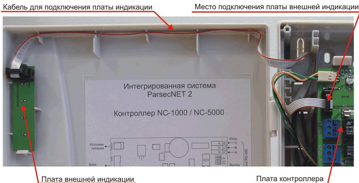
Рисунок 13. Схема подключения платы внешней индикации.
