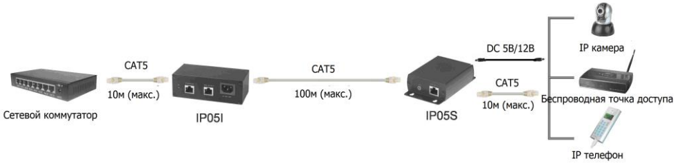
Рис.2 Схема подключения инжектора IP05I и сплиттера IP05S.
