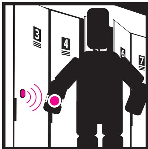
**4** Повторное касание этим же браслетом этого же считывателя: откроет шкафчик, удалит номер браслета из памяти, задвинет засов. Шкафчик свободен.
