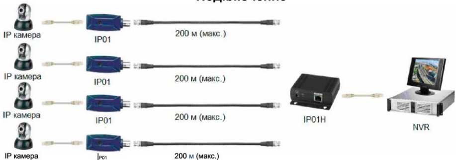
Рис. 2 Схема подключения IP01H
