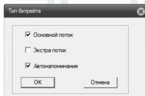
При подключении появляется запрос, предлагающий отображать основной или альтернативный видеопоток, а также установить авто подключение каналов.
