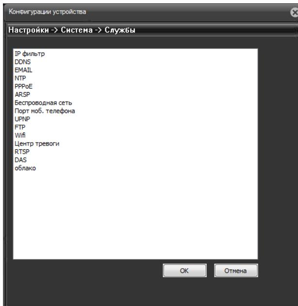
**IP – фильтр** – настройка списка IP адресов, с которых возможен или невозможен доступ к камере.
