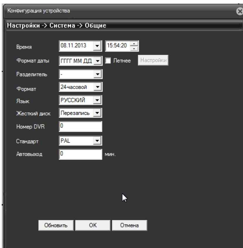
В данном меню производятся основные настройки даты и времени камеры, выбор языка интерфейса, настройка интервала автоматического отключения пользователя (**Авто выход**) и настройка имени устройства.
