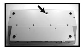
**ШАГ 2**: Подключите порт COM1 или COM2 компьютера к клавиатуре при помощи кабеля RS-232 D-Sub9 (прямой кабель, не кроссовый Нуль-модемный).
