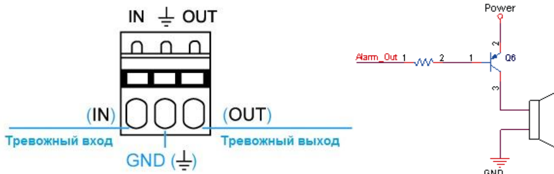
Рис.2.2.1. Схема подключения тревожных входа / выхода видеокамеры LTV-ICDM1-B423L-F
