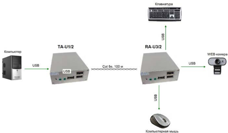
Рис.2 Подключение комплекта TA-U1/2+RA-U3/2
