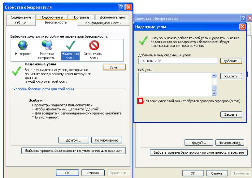
Откройте свойства IE, вкладку «Безопасность». Выделите пункт «Надежные узлы», нажмите кнопку «Узлы». Добавьте в список надежных узлов IP адрес вашего DVR.
