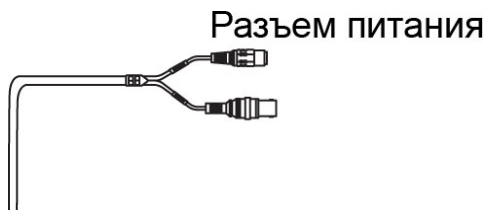
Рис.3.2.1. Подключение питания видеокамеры LTV-CDH-6211LH-V5-50
