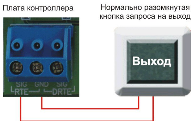
Рисунок 14. Схема подключения кнопки запроса на выход
