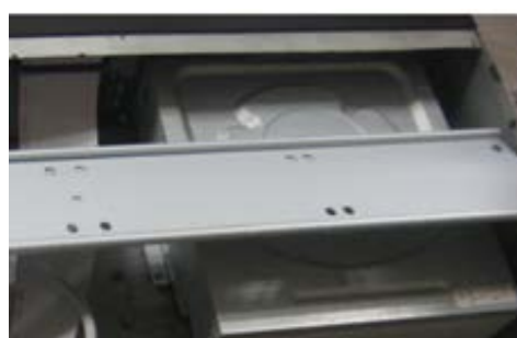
Рис. 1.2.6. Установка CD/DVD привода
