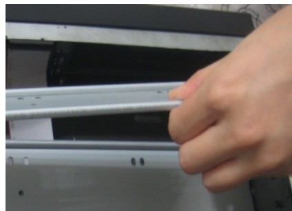
Рис. 1.2.2. Демонтаж верхней панели крепления HDD
