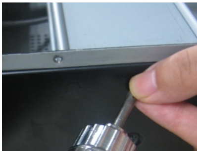
Рис. 1.1.1. Демонтаж верхней панели крепления HDD
