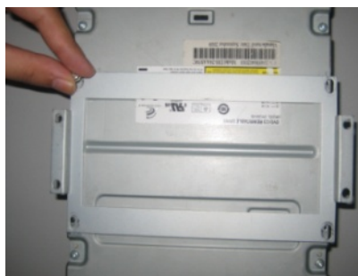
Рис. 1.2.3. Установка CD/DVD привода
