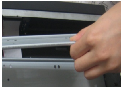
Рис. 1.1.2. Демонтаж верхней панели крепления HDD
