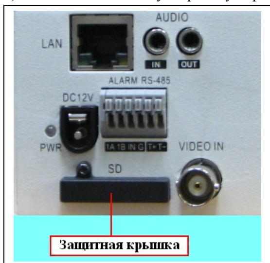
Рис. Защитная крышка установлена
