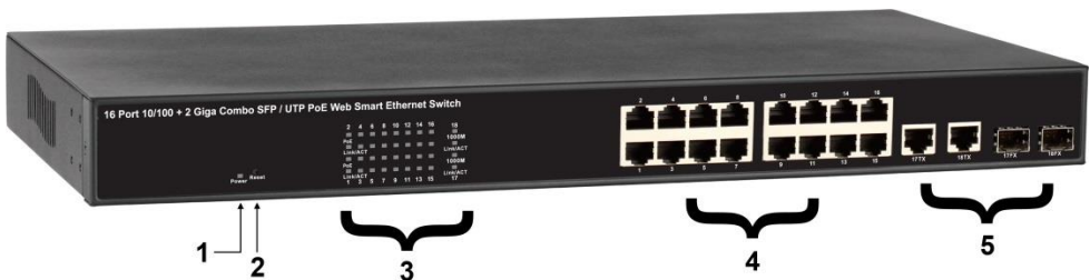
Рис. 1.1 Коммутатор SW-61622/MB , вид спереди
