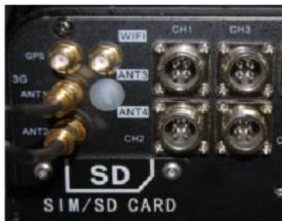
6. Установите обратно панель SIM/SD и подсоедините две антенны для получения сигнала 3G сети.
