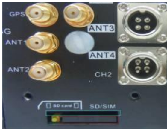
2. Снимите панель SIM/SD. Держатель SIM-карты – красный, держатель SD-карты – синий.
