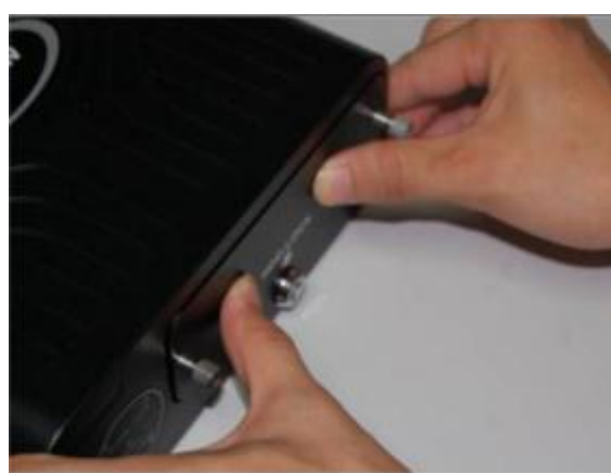
8. После установки жестких дисков вставьте корзину обратно в видеорегистратор, закрутите шурупы и закройте на ключ (заблокируйте).
