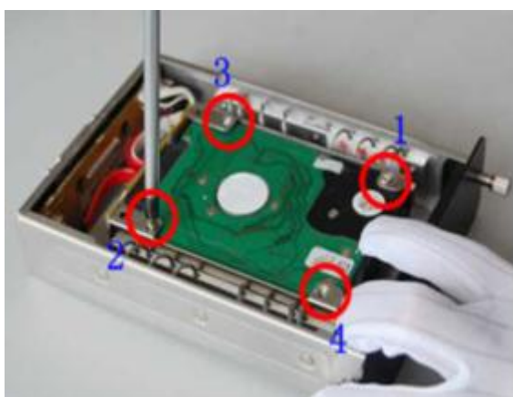
7. Закрутите шурупы в порядке, показанном на рисунке, чтобы закрепить два диска отдельно.
