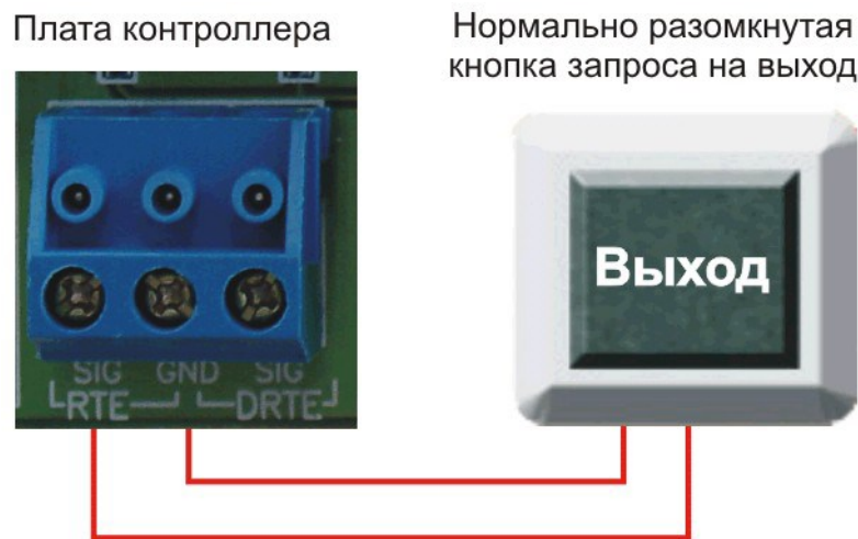
Рисунок 16. Схема подключения кнопки запроса на выход
