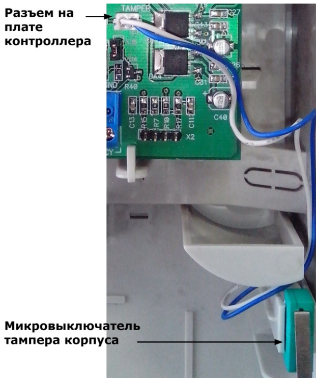
Рисунок 23. Подключение тампера корпуса
