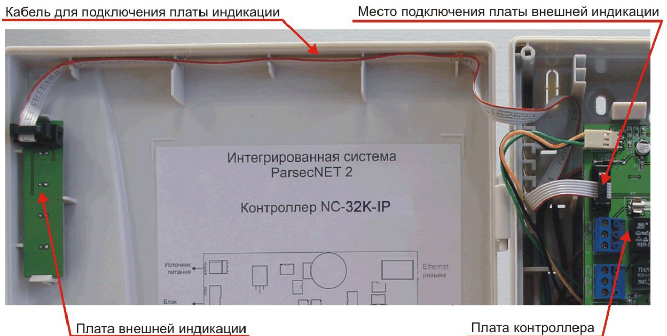
Рисунок 27. Схема подключения платы внешней индикации
