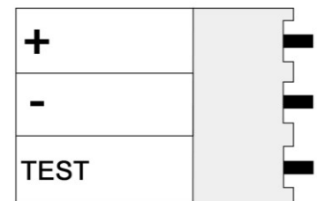
Рисунок 3. Назначение контактов разъема POWER
