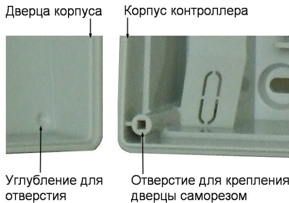
Рисунок 5. Схема «жесткого» крепления дверцы к корпусу контроллера
