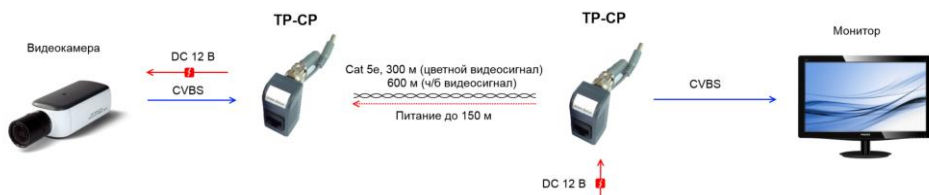
Рис.2 Схема подключения TP-CP
