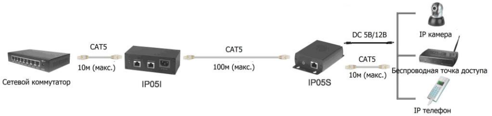
Рис.2 Схема подключения инжектора IP051 и сплиттера IP05S.
