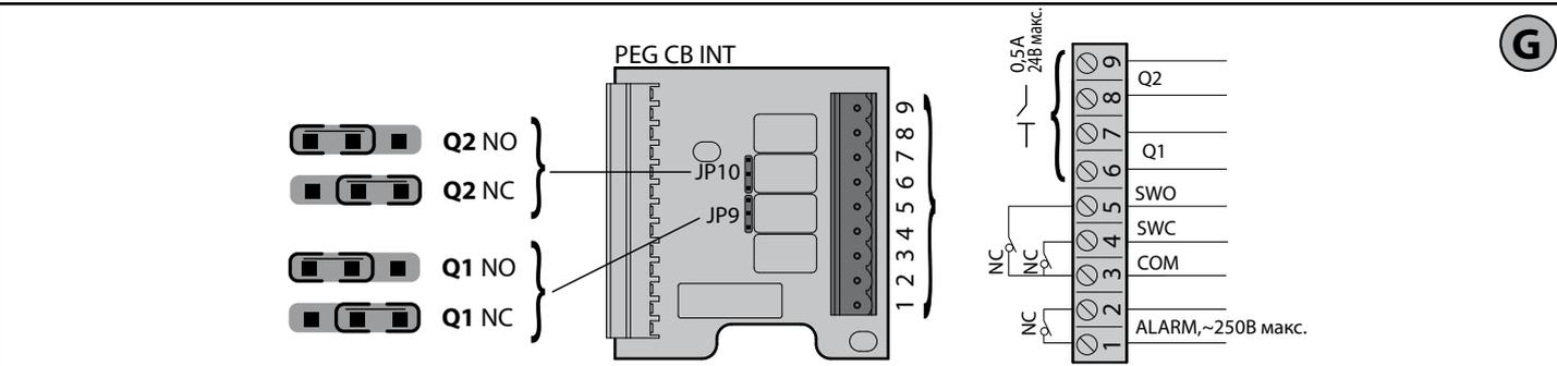
РЕГУЛИРОВКА КОНЦЕВОГО ВЫКЛЮЧАТЕЛЯ
