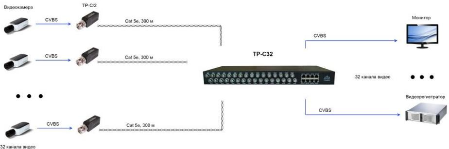
Рис.2 Схема подключения TP-C32
