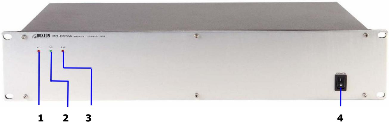
**1. Светодиод AC красного цвета** - Указывает на наличие входного переменного напряжения 220В 50Гц, на наличие выходного переменного напряжения на одной из выходных розеток 220В 50Гц (поз.7 задней панели), на наличие постоянного напряжения 24В на выходных клеммах 7 и 8 (поз.8 задней панели).
