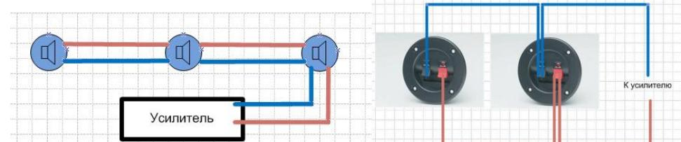
Если громкоговоритель не замыкающий (конечный) в системе, а является одним из звеньев цепочки, то подключаем к нему входящий и выходящий провод (предварительно соединив его по цветам **синий с синим, красный с красным**). На задней панели усилителя имеются либо клеммы, либо зажимы для выхода на громкоговорители. Необходимо использовать значения COM (или "0") и 100B. К контакту COM мы подключаем **синий** провод, что идет от громкоговорителей, к контакту со значением 100B - **красный**.
