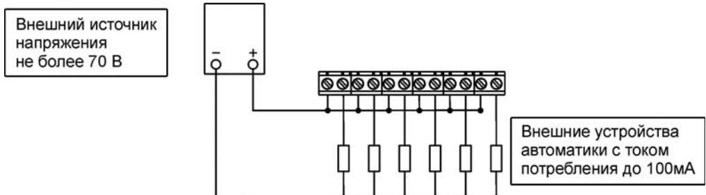
СХЕМА ПОДКЛЮЧЕНИЯ ИСТОЧНИКА
