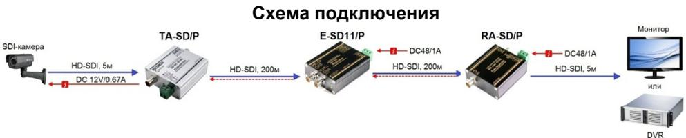
Рис. 7 Схема подключения передатчика TA-SD/P, повторителя E-SD11/P и приёмника RA-SD/P.
