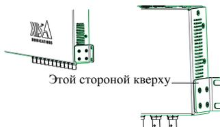
**Прим.:** Каждое основание должно закрепляться к соответствующему видеосерверу по соответствующим углам в зависимости от необходимости монтажа на стену или рейку.
