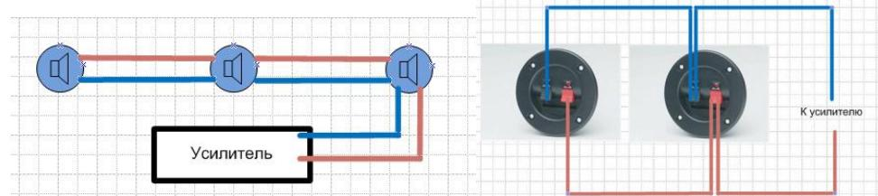
Если громкоговоритель не замыкающий (конечный) в системе, то подключаем к нему входящий и выходящий провод (предварительно соединив его по цветам [синий с синим](#), [красный с красным](#)). На задней панели усилителя имеются либо клеммы, либо зажимы для выхода на громкоговорители. Необходимо использовать значения COM (или "0") и 100В (30В/70В). К контакту COM мы подключаем [синий](#) провод, что идет от громкоговорителей, к контакту со значением 100В (30В/70В) - [красный](#).
