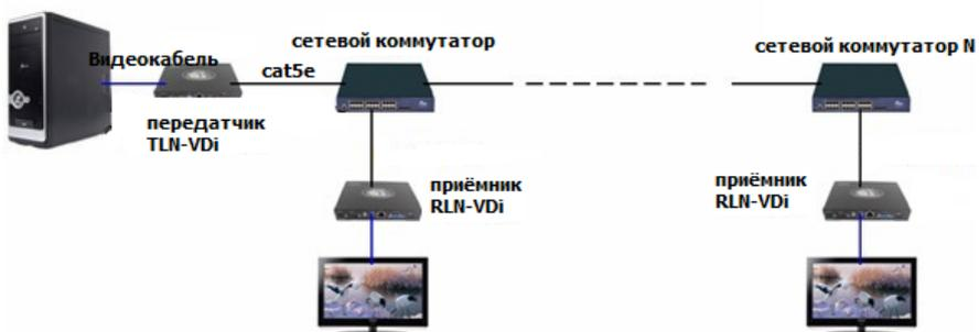
Рис.7 Схема подключения передатчика TLN-VDi и приемников RLN-VDi каскадом.
