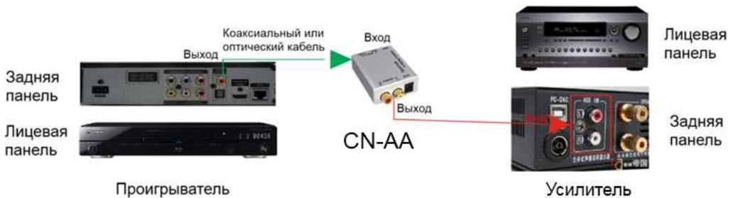
Рис. 3 Схема подключения преобразователя CN-AA
