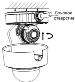
Рисунок 2-3 Прокладка кабеля через боковое отверстие
