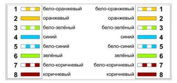
Подключение IP-камеры напрямую к ПК производится при помощи «кросс» кабеля, имеющего следующую разводку:
