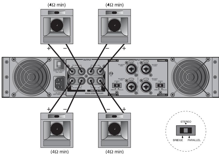
\* ВНИМАНИЕ: подключение акустических систем в параллельном режиме производится аналогично стерео-режиму, используемые входы усилителя при этом: входы 1 и 3 каналов.
