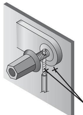
QD-4960 способен выдавать большие токи, поэтому перед подключением акустических систем убедитесь, что у них есть запас по мощности. Если максимальная мощность акустических систем меньше номинальной мощности усилителя, рекомендуется использовать предохранитель, как показано на схеме.
