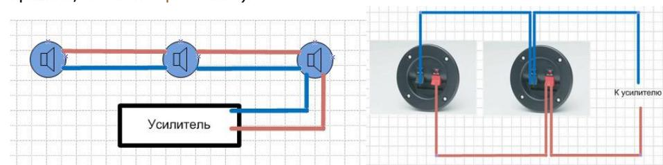
Если громкоговоритель не замыкающий (конечный) в системе, а является одним из звеньев цепочки, то подключаем к нему входящий и выходящий провод.
