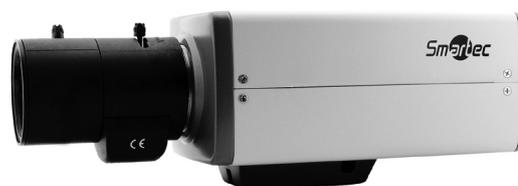
IP-камера классического дизайна STC-IPM3086A использует 1/2.8" 2-мегапиксельную КМОП-матрицу. Разрешение изображения Full HD (1920x1080) и точность цветопередачи позволяют применять STC-IPM3086A на объектах с повышенными требованиями к качеству видеосигнала. IP-камера предназначена для применения как внутри помещений, так и на улице при установке в термокожух.
