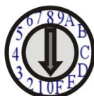
Рис. 5 Поворотный переключатель на задней панели передатчика/приёмника.
