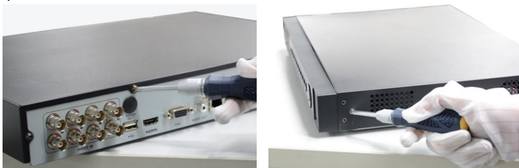
Рис.2.1. Снятие крышки LTV-TVР-0430-НV
