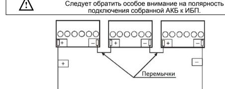
Рисунок 1. Схема соединения аккумуляторов в батарею.
