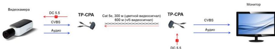
Рис.2 Схема подключения TP-CPA
