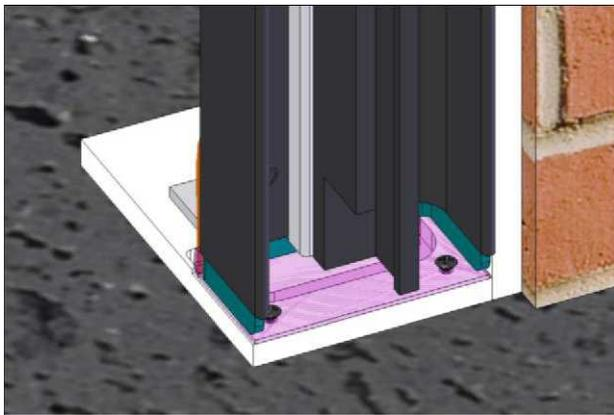
**Уплотнительная полоса, используемая внутри боковой направляющей, стала больше (теперь мы используем PVC полосу шириной 250mm)**
