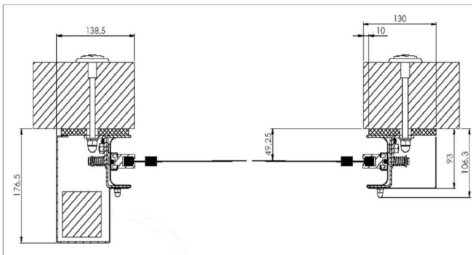
Траверса стала шире и оборудована уплотнителем для лучшего прилегания к проёму и уменьшению теплопотерь.
