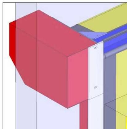
Для обеспечения лучшего соединения с защитными коробами, пластиковые теплоизолирующие прокладки, между боковой стойкой и стеной, стали шире.
