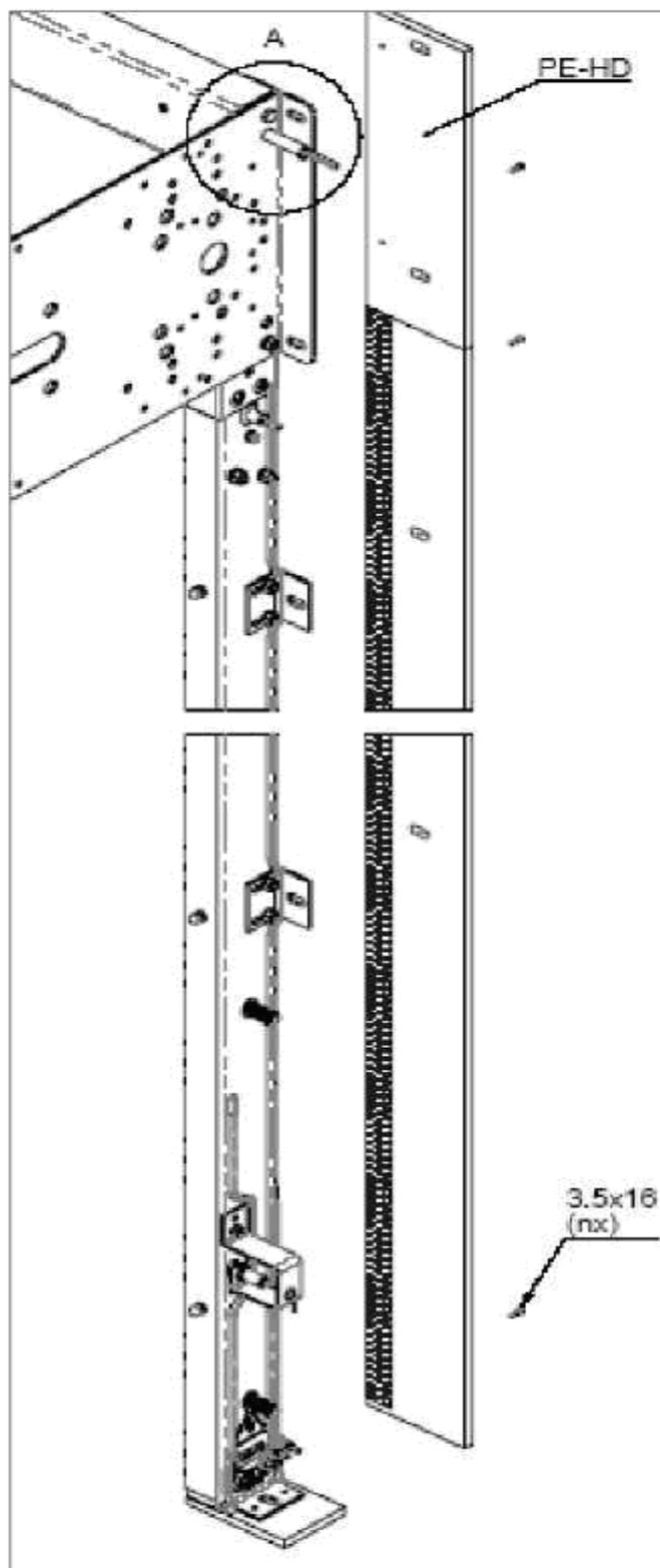
Кожух для противовеса используется от модели D501 и объединяет функции как декоративного кожуха, так и кожуха противовеса.
